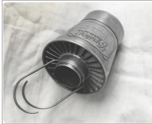
Ilustración 2. Primer filtro de aire, hecho de manera artesanal.
