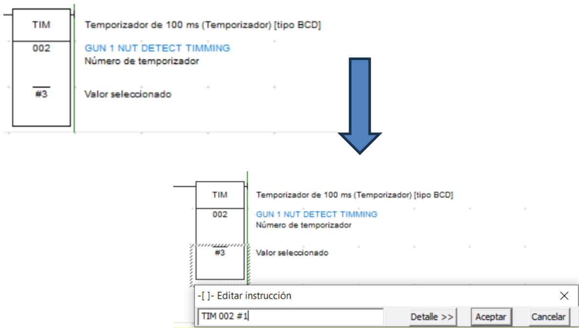
Ilustración 33 Ajuste de tiempo de retardo de presión de pinza.
