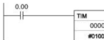
Ilustración 27 Función TIMMER de PLC
