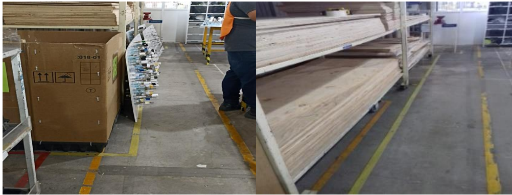
Ilustración 48, Tablero Recargado Sobre Racks de Material, Elaboración Propia.
