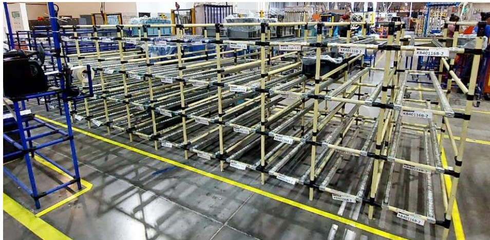
Ilustración 5.1.19. implementación del sistema Kanban para el área de lavado en la línea de Ford y stellantis. Fuente: elaboración propia.2023.
