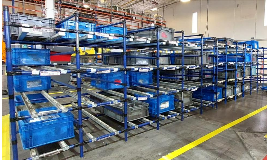
Ilustración 5.1 1 Sistema de abastecimiento Kanban para Nissan en el área de corte. Fuente: elaboración propia.2023.
