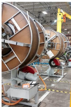
Ilustración 4.1 4 Rollos de "Coil" instalados en las cortadoras. Fuente: Elaboración propia, 2023.
