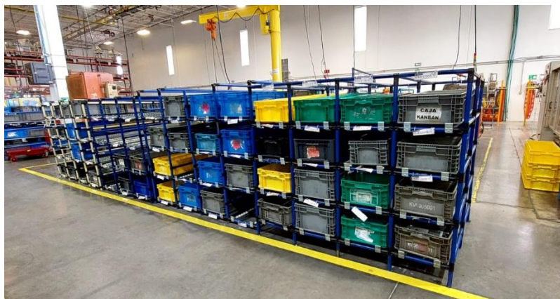
Ilustración 5.1 3. Sistema de abastecimiento Kanban de stellantis y ford para el área de corte. Fuente: elaboración propia.2023.
