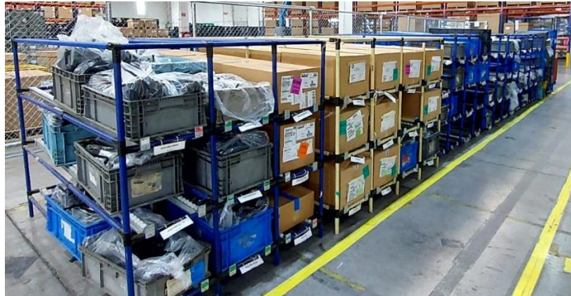
Ilustración 5.1.15. Implementación del sistema Kanban en el área de formado. Fuente: elaboración propia.2023.
