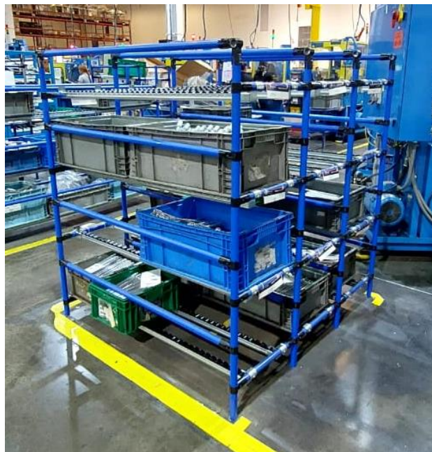
Ilustración 5.1.18 implementación del Kanban en el área de formado. Fuente: elaboración propia.2023.
