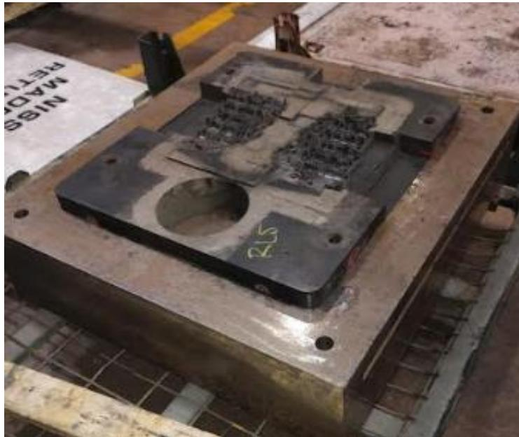
*Ilustración 5. 5 Impresión ensamblada en placa*
