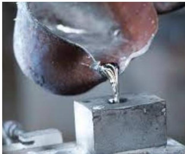
*Ilustración 3. 1 Vaciado de aluminio líquido*
