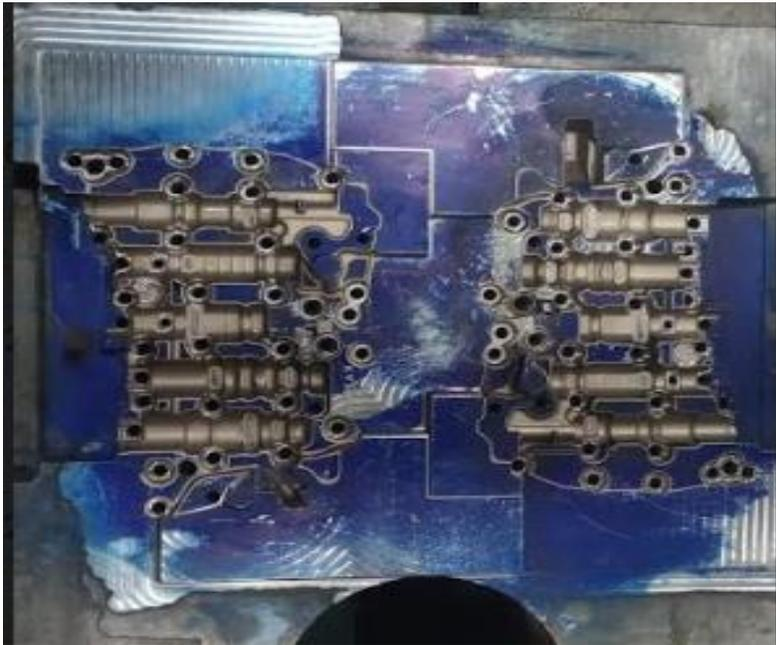
*Ilustración 5. 3 Impresión después de maquinado completa*
