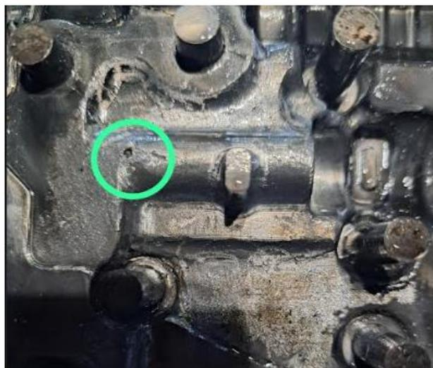
*Ilustración 4. 4 Desgaste en impresión de Aro Lower Fuente: JMEX*
