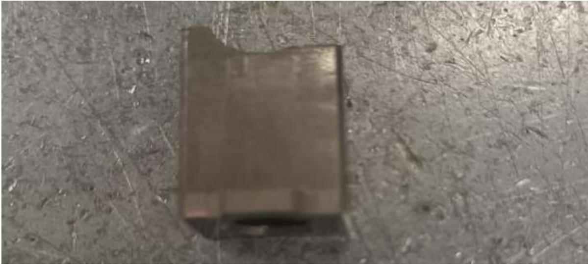
*Ilustración 4.3.3 Cortador de rebaba en terminal.*
