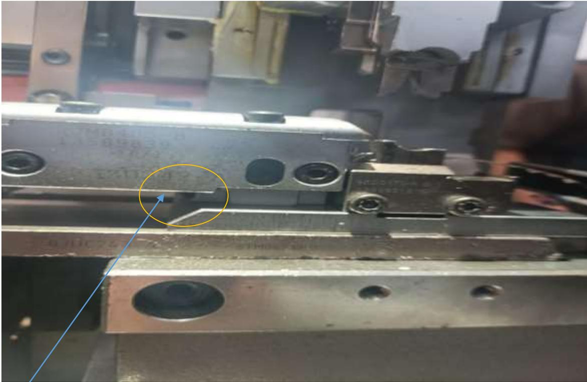
*Ilustración 4.3.9 opresor del tornillo de la campana.*
