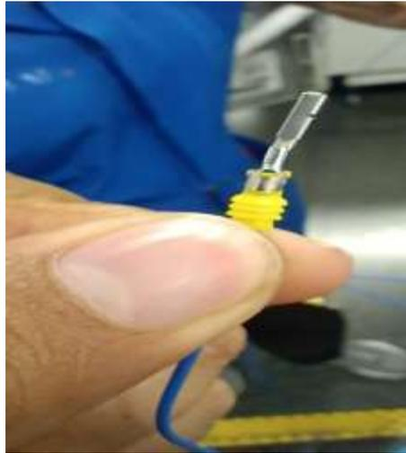
*Ilustración 4.3.11 Terminal girada.*
