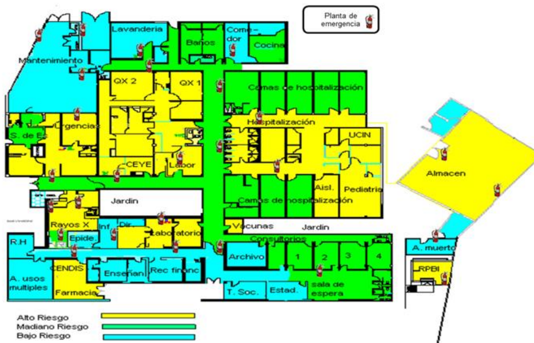
Ilustración 25. Ubicación de extintores en el H.G.P.A.
