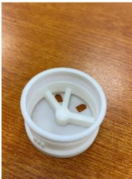
*Ilustración 32 rediseño de tapa impresa parte superior*
