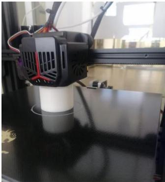
*Ilustración 8 impresión de envase en impresora 3D*
