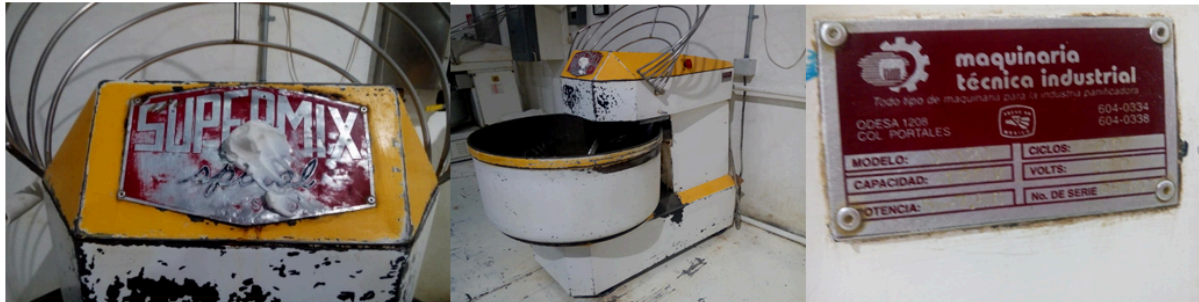
Figura 10. Batidora Supermix de dos velocidades que se utiliza para batir masa de bolillo.
