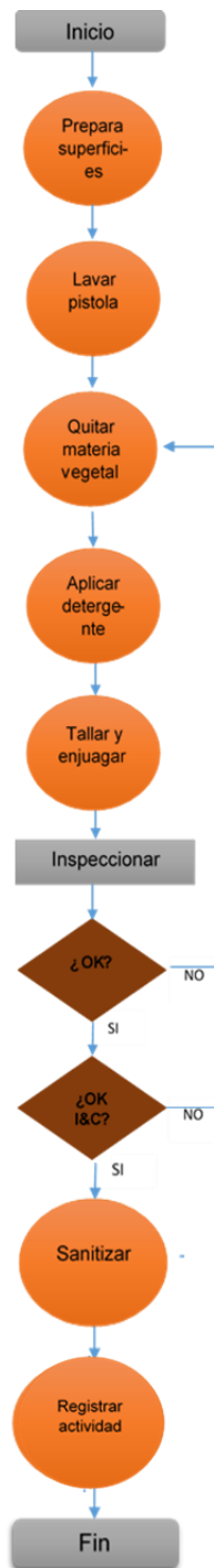
Figura 3 Diagrama de flujo actual de la actividad de saneamiento de equipos y utensilios de contacto
