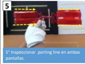
5° Inspeccionar parting line en ambas pantallas.
