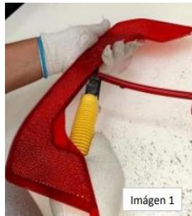
2° Inspeccionar el corte de canal
