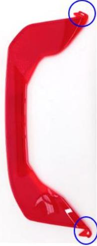
**3°** Inspeccionar zona C para confirmar que no exista disparo corto o fractura
