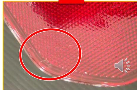
Figura 4.12 Octavo defecto en la pieza. Mancha.
