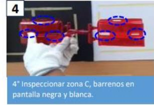
4° Inspeccionar zona C, barrenos en pantalla negra y blanca.
