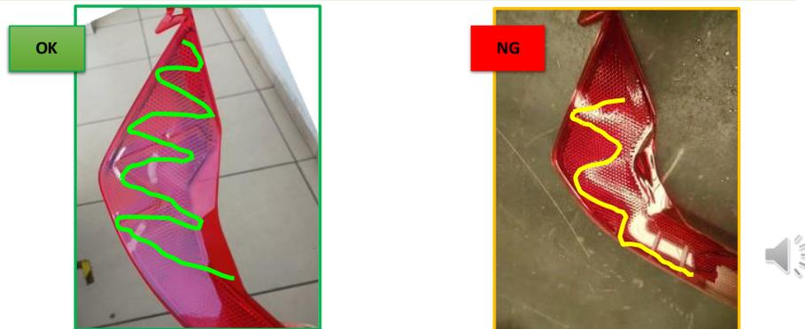
Figura 4.8 Cuarto defecto en la pieza. Rechupe.
