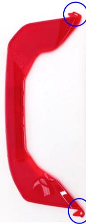
3° Inspeccionar zona C para confirmar que no exista disparo corto o fractura
