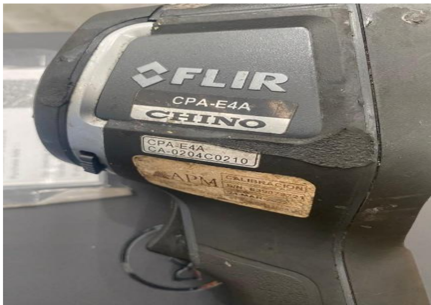
Ilustración 24 Pirómetro laser, dañado.
