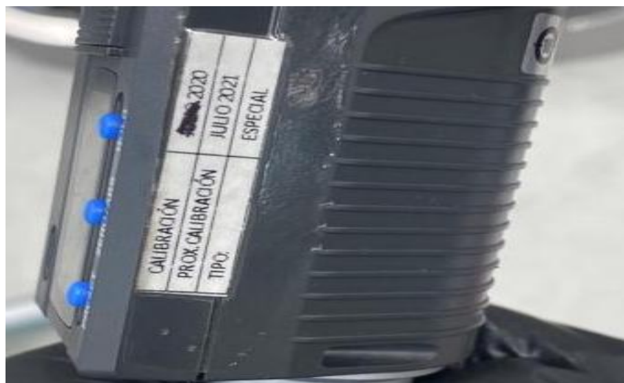
Ilustración 22 Micrómetro con Calibración vencida
