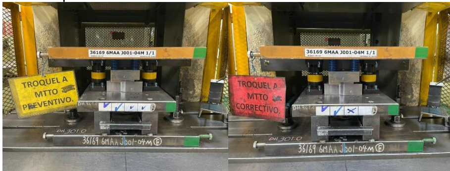
Imagen 24 troqueles con tarjetas de mantenimiento
