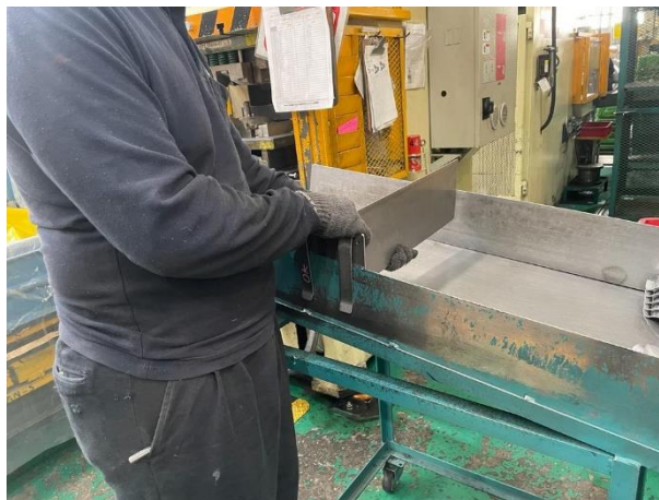
Imagen 15 ejemplo de colocación de separado
