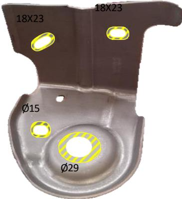
**2** ÁREAS DE ASENTAMIENTO SIN REBABAS, MARCAS DE SCRAP O CUALQUIER DEFORMACIÓN QUE AFECTE EL ENSAMBLE. (VER PIEZA MÁSTER)
