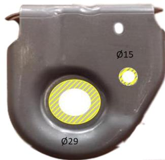
**3** EL LADO RH DEBE TENER 5 BARRENOS LIBRES DE JALAMIENTOS Y / O ALGUNA DEFORMACIÓN.
