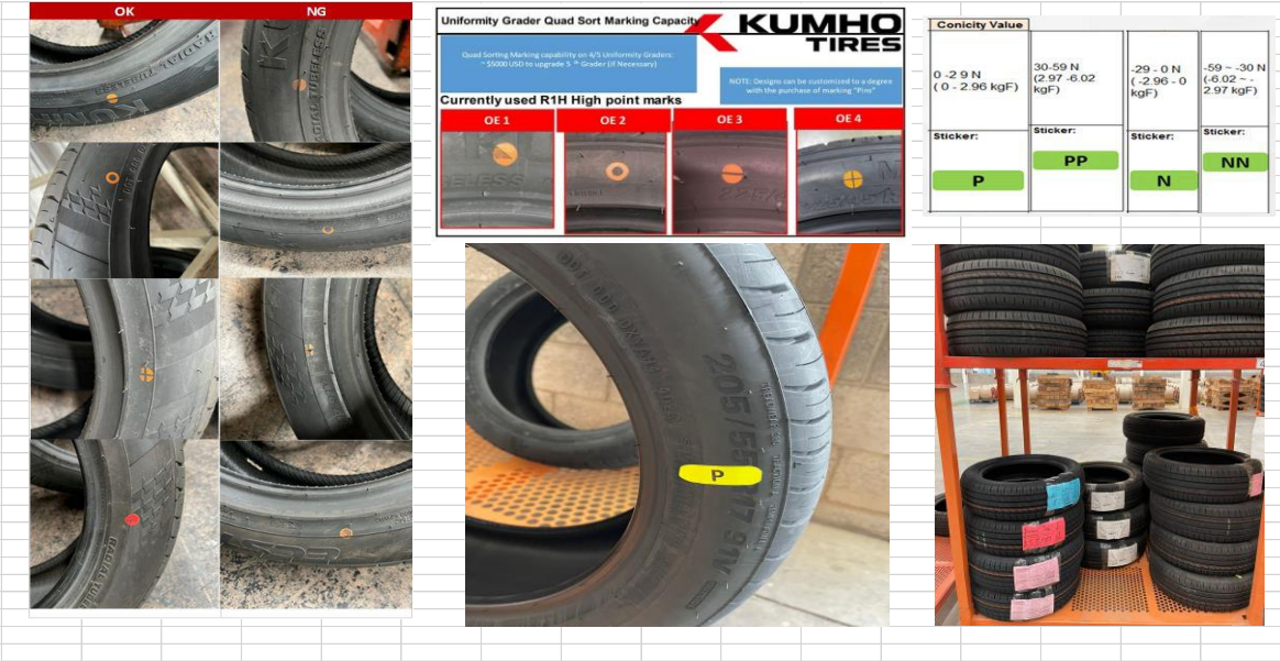
Ilustración 27. Especificaciones de cliente para controlar piezas sospechosas y separación de inventario OK.
