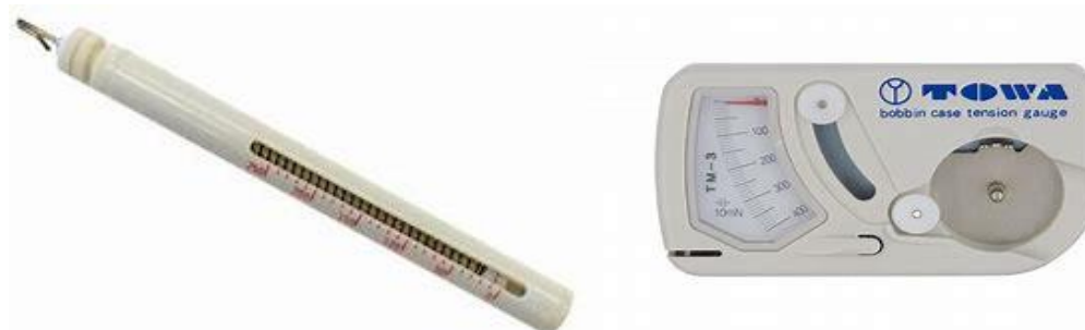
Imagen 6 Instrumentos para tensionar maquina bordadora (aguja y bobina)
