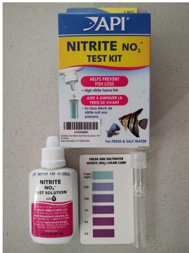
Figura 6. Kit colorímetro e medición de nitrito
