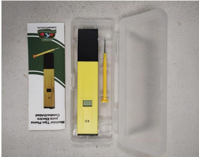
Figura 3. Medidor de conductividad eléctrica.
