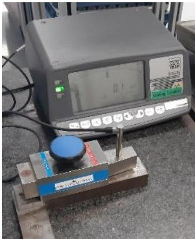
Retirar el medidor de la escuadra y comenzar con las mediciones solo posicionando el medidor de la manera como lo indica la siguiente tabla.
