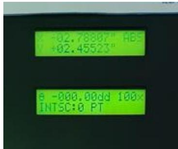
Colocar el nivel digital en el comparador para ajusta en 0 verificar que ambos estén en 0 tanto el nivel como el comparador.
