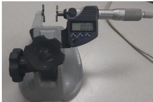
Una vez que estén los alambres colocados en el micrómetro de puntas planas colocar el gage de tal manera que los alambres queden en medio de las cuerdas y tomar las lecturas.
