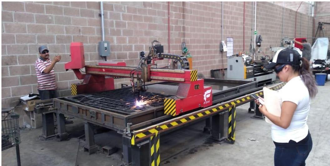
*Ilustración 36.- Toma de tiempos en líneas de producción en la operación de corte plasma en pantógrafo.*
