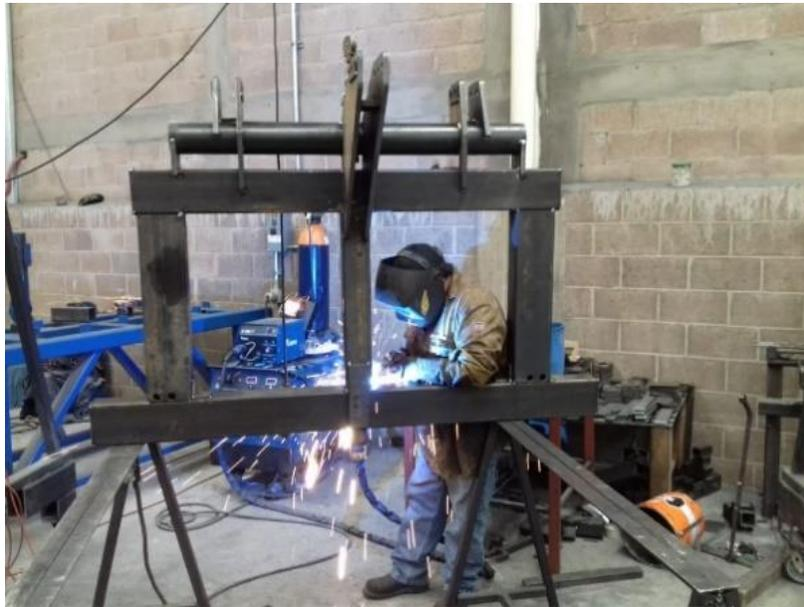
*Ilustración 29.- Puntear con micro alambre.*
