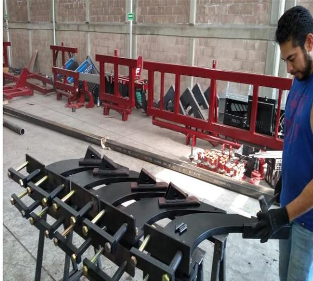
*Ilustración 10.- Acoplamiento de partes con herramientas manuales.*
