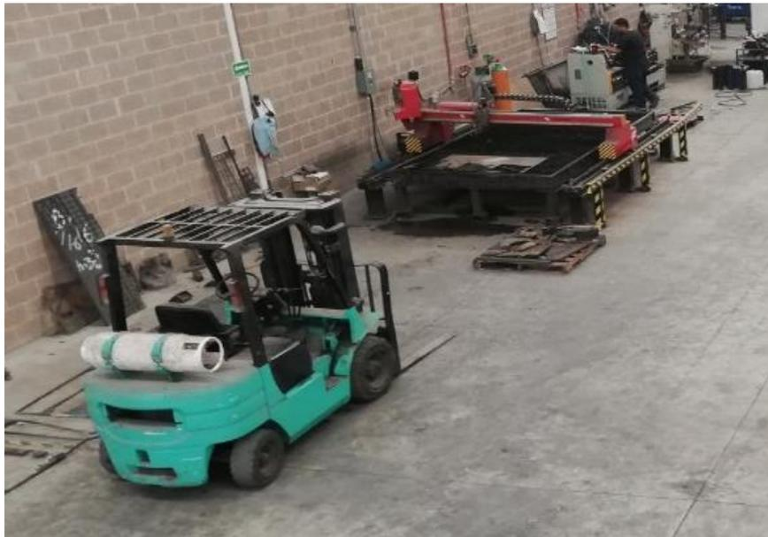
*Ilustración 14.- Carga de material en pantógrafo.*
