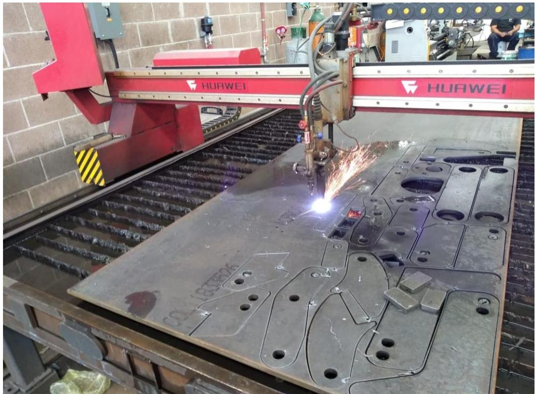
*Ilustración 24.- Oxicorte en pantógrafo CNC.*
