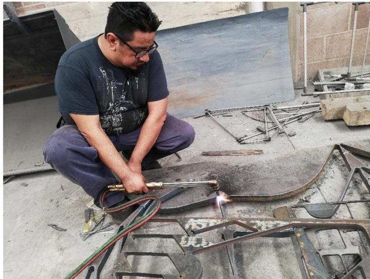
*Ilustración 23.- Oxicorte con equipo manual.*
