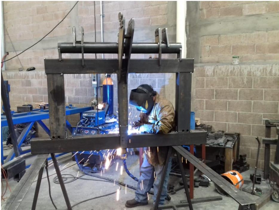
*Ilustración 31.- Resoldar con micro alambre.*
