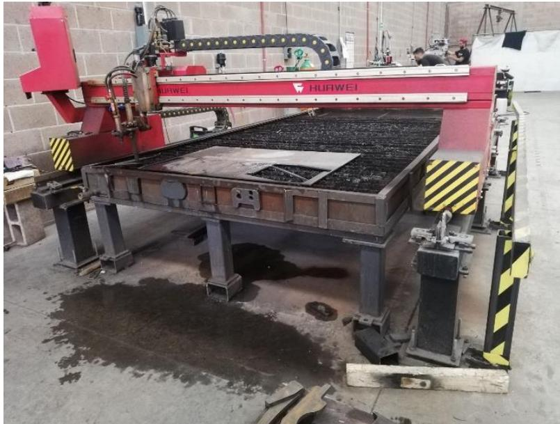
*Ilustración 17.- Corte plasma en pantógrafo CNC.*
