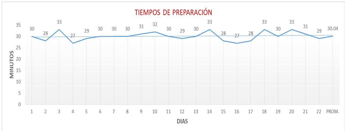
Ilustración 34.- Tiempos de preparación de materiales para ensamble.
