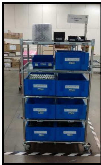
Figure 29 Kiteo de la línea de ventana
