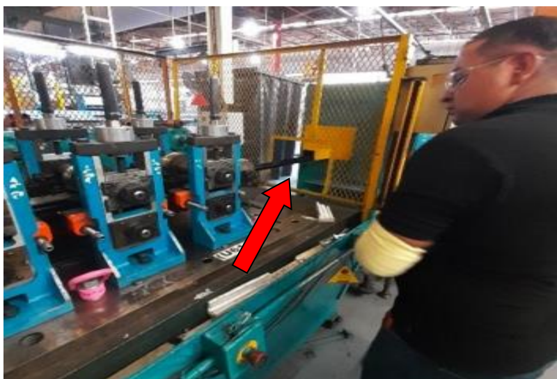
Ilustración 129, perfil pasando por postformador.
