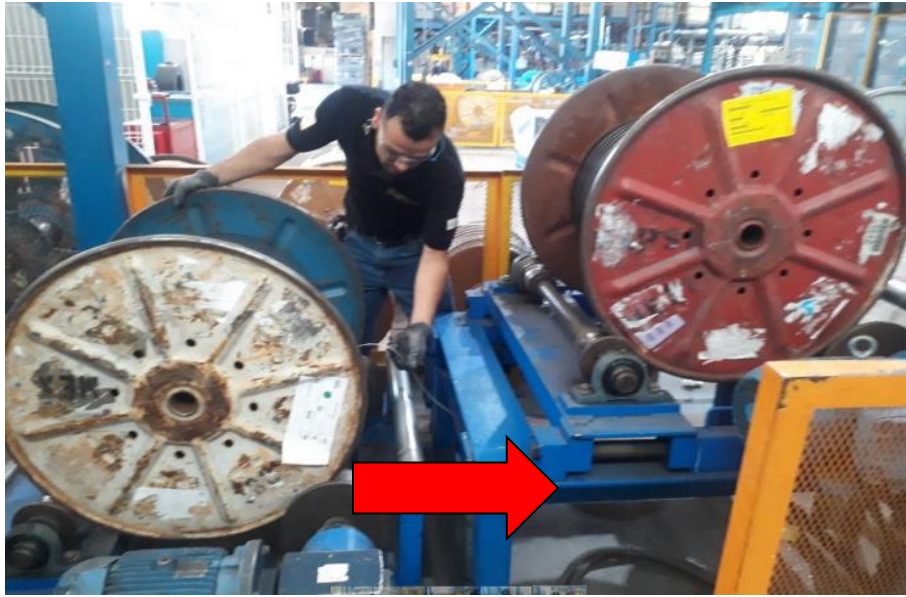
Ilustración 32, pasando carrier por los rodillos de arrastre.
