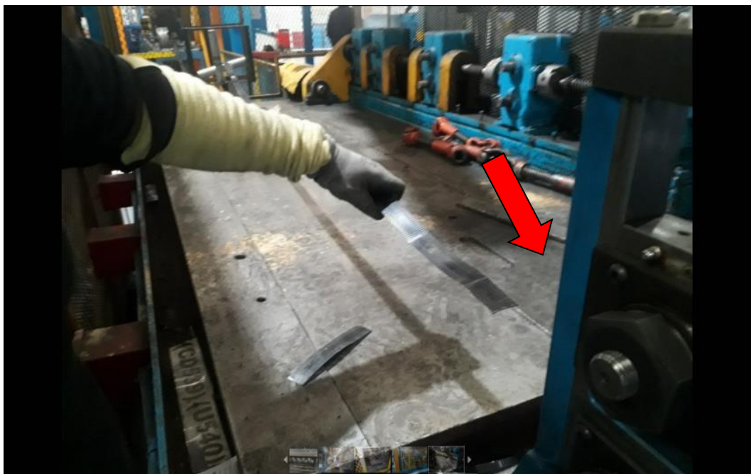
Ilustración 36, introduciendo carrier al preformador.
