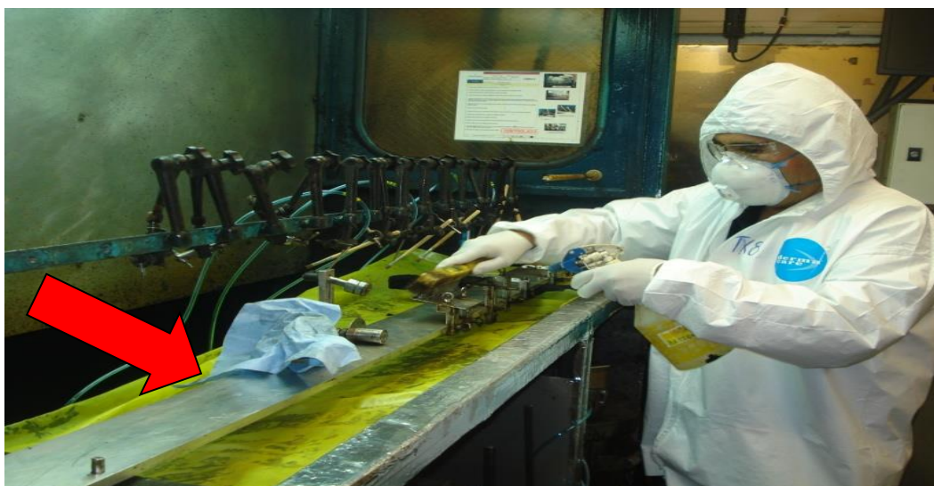
Ilustración 54, limpieza de guías de pegamento o coating.
