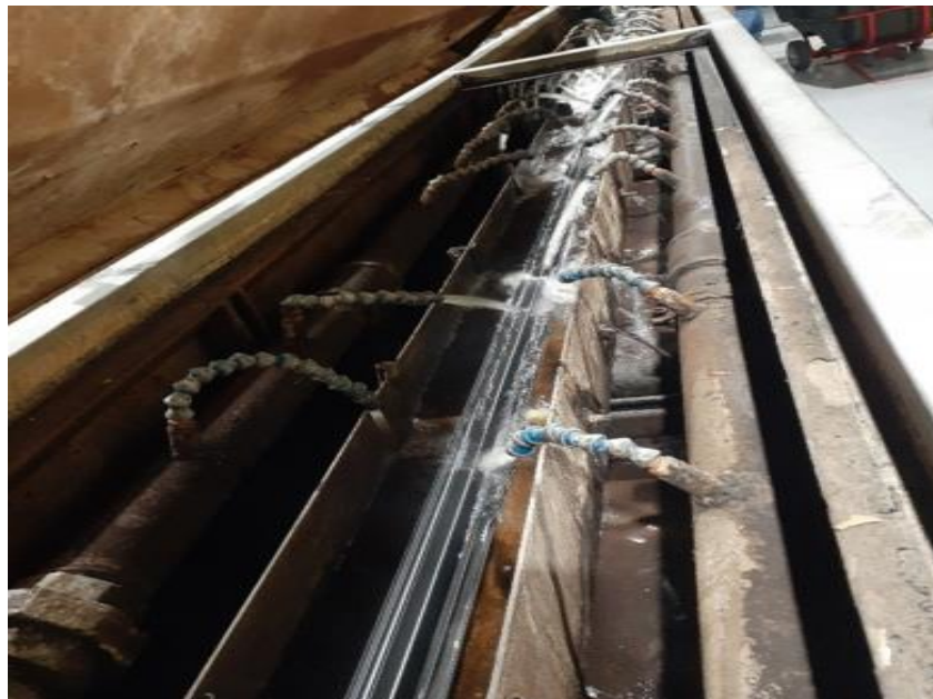
Ilustración 120, enfriamiento a base de agua.
