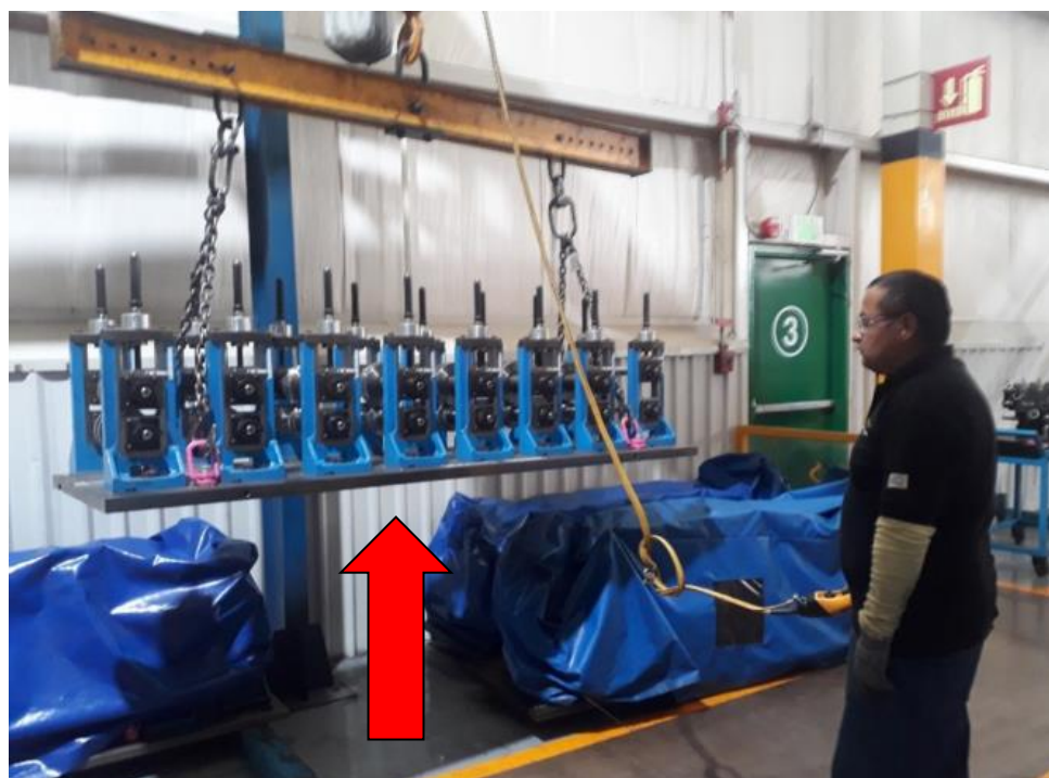
Ilustración 27, se eleva preformador con la grúa.
