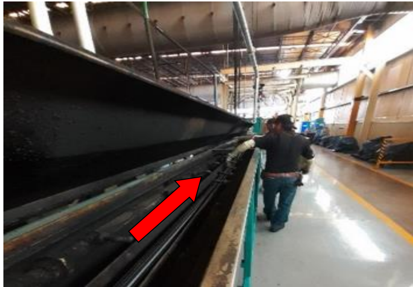
Ilustración 119, perfil pasando por enfriador 1.
