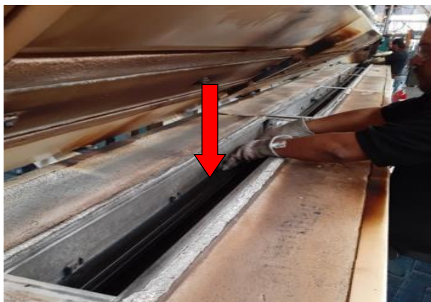
Ilustración 116, acomodo del perfil en los rodillos dentro de los hornos.
