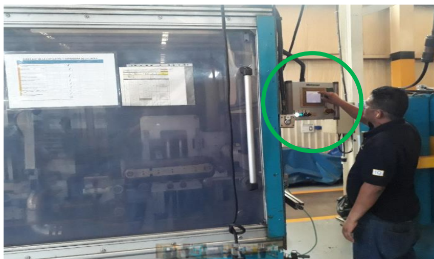
Ilustración 108, preparando cortadora para la longitud a cortar.
