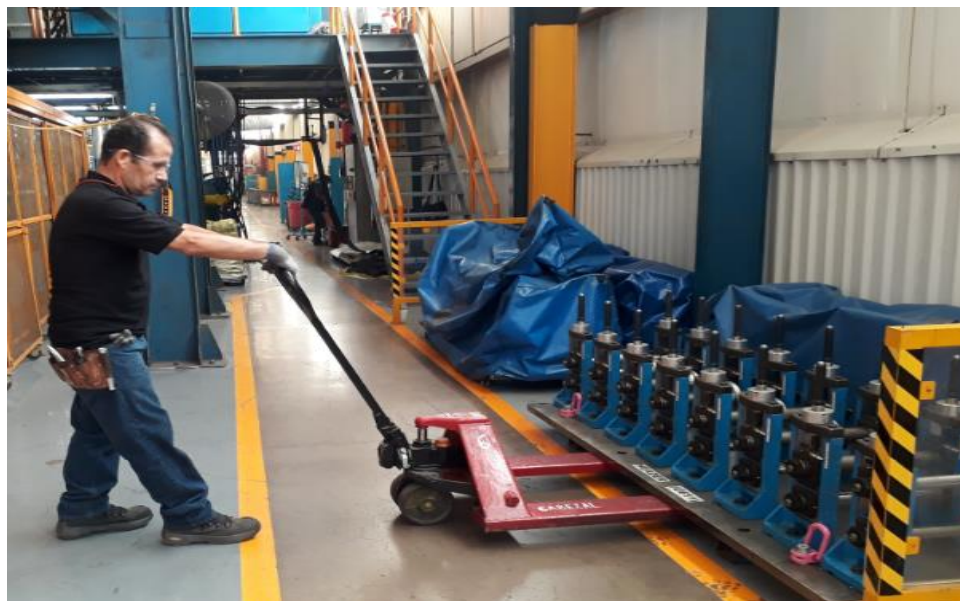
Ilustración 26, acercando preformador a la grúa.
