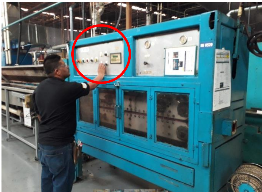
Ilustración 66, programando velocidad de puller.
