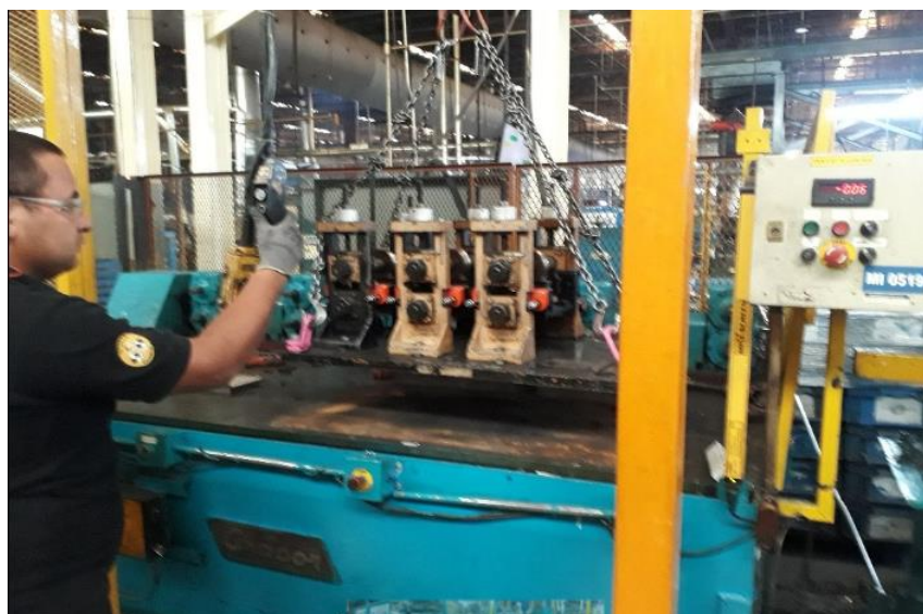
Ilustración 105, realizando cambio de postformador.
