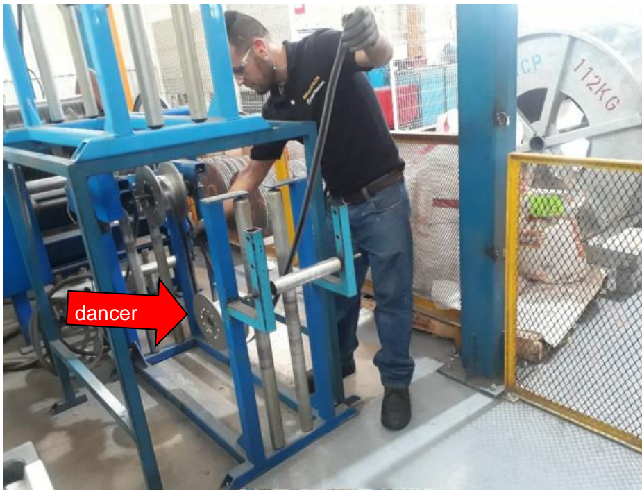
Ilustración 33, instalando carrier en dancer o balancín.
