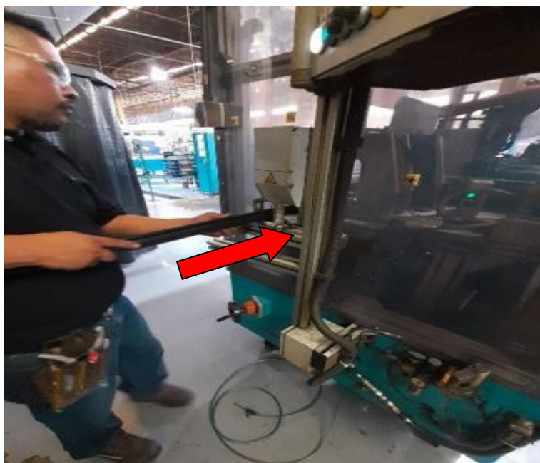
Ilustración 131, introduciendo perfil a cortadora.
