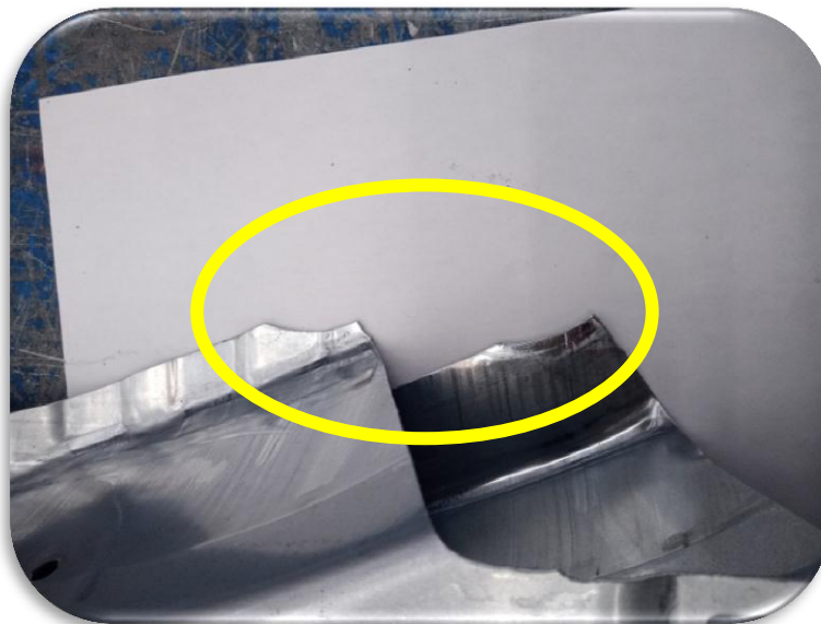
Ilustración 26. Pruebas de estampado de piezas con falta de material pieza LH
