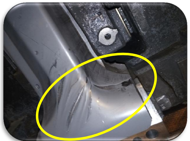
Ilustración 30. Pruebas de estampado con arruga
