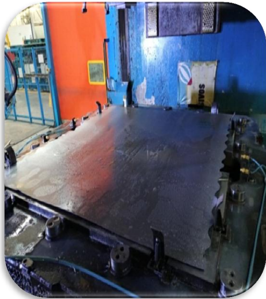
Ilustración 24. Pruebas de plantilla en operación de embutido maquina transfer
