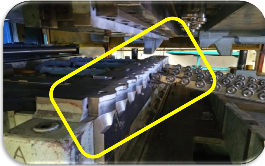
Ilustración 18. Cuchilla de scallop en troquel
