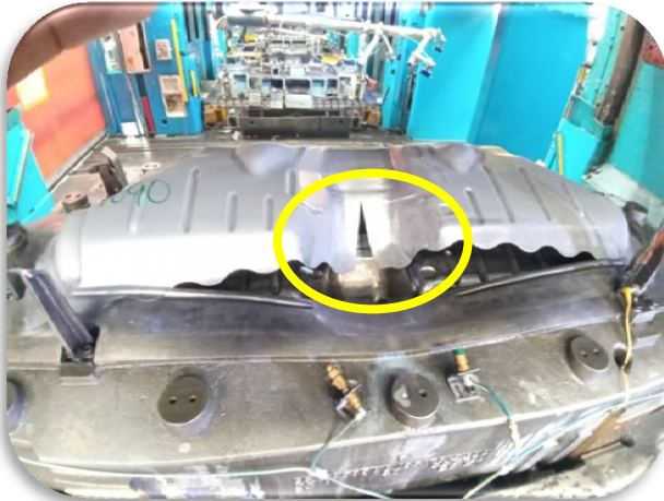
Ilustración 28. Pruebas de estampado con fractura
