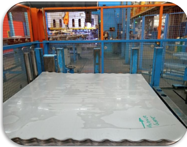
Ilustración 39. Montaje de plantilla en mesa de carga para inicio de proceso con los robots
