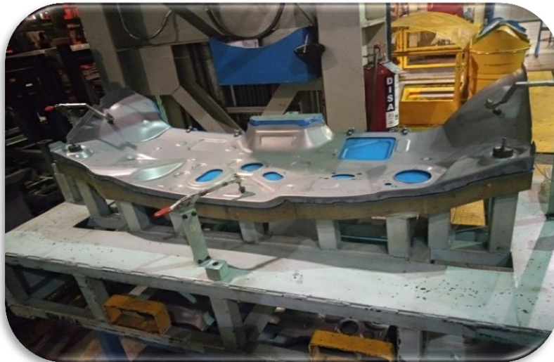
Ilustración 33. Validación de forma contra escantillón pieza dash lower
