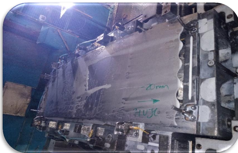
Ilustración 37. Marcaje de flujo de plantilla en operación de embutido línea tándem
