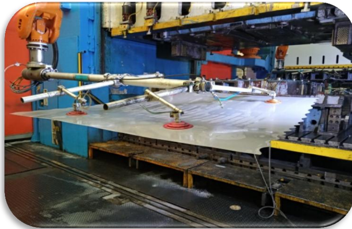
Ilustración 41. Revisión de trayectoria de robot a troquel de embutido
