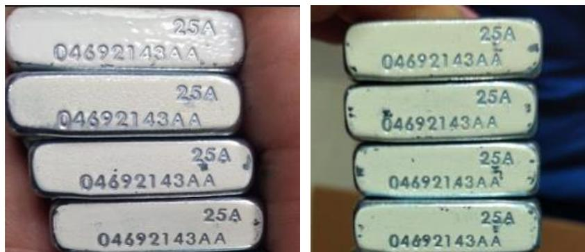
Figura 6 cubierta metálica dañada en el proceso de troquelado.
