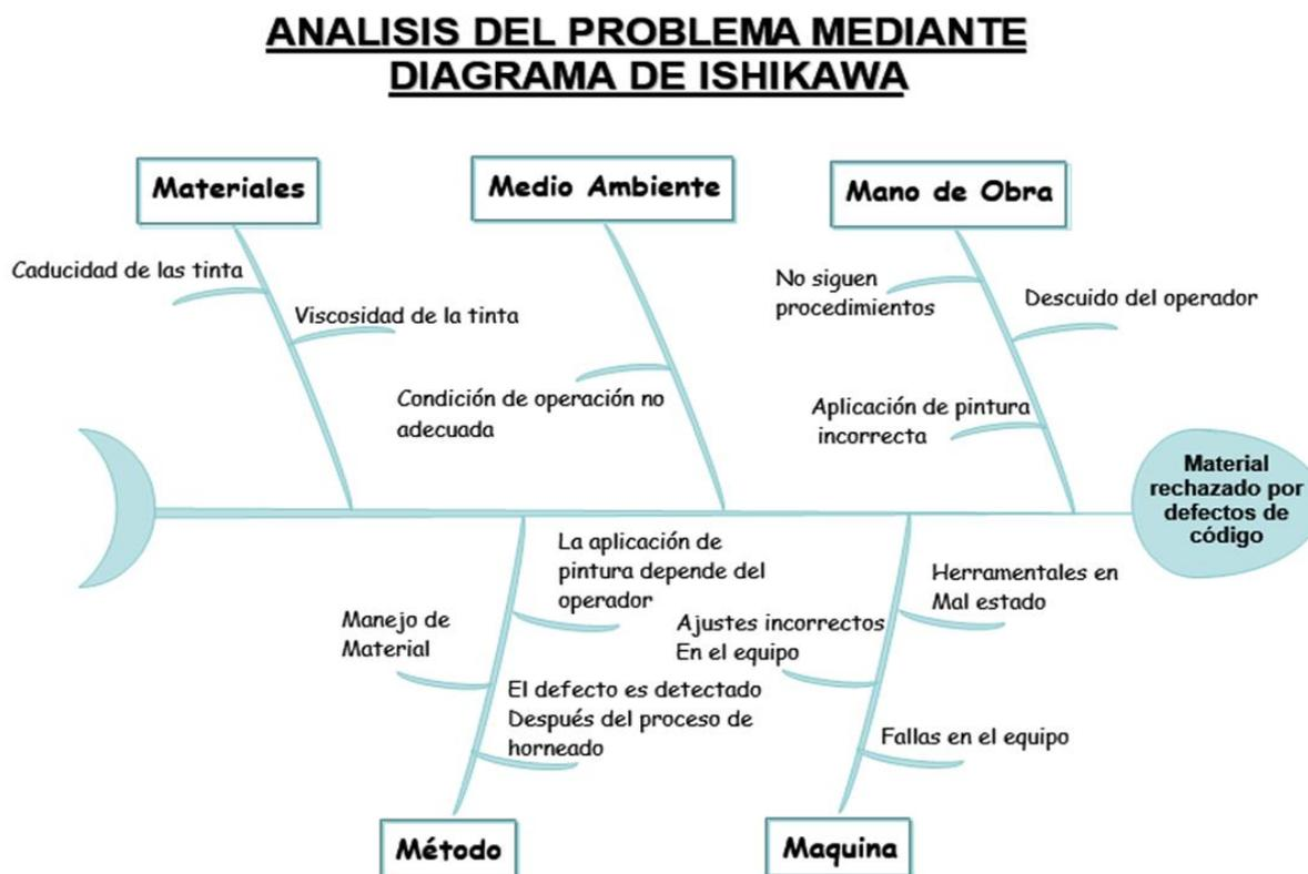
A modo de conclusión, podemos mencionar que la causa principal gira en torno al manejo del material, herramientas en mal estado y fallas en el equipo, ya que los dos primeros defectos van relacionados con el desgaste de los dados del troquel o alguna posible falla del equipo y el tercer defecto se refiere a falta de código el cual puede ser causado por un mal manejo del material de una operación a otra.
