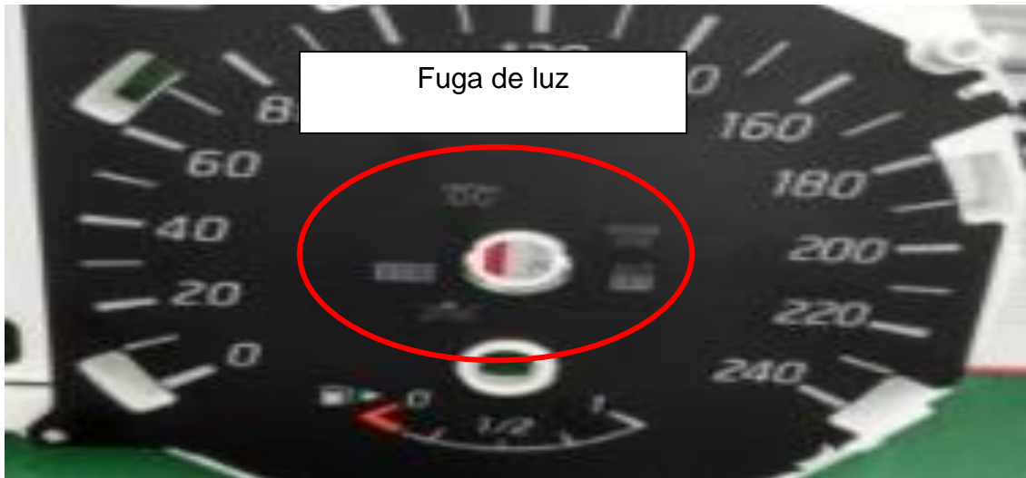
Imagen 2.2 En esta imagen se muestra la zona donde se encuentra la fuga de luz como defecto de meter.
