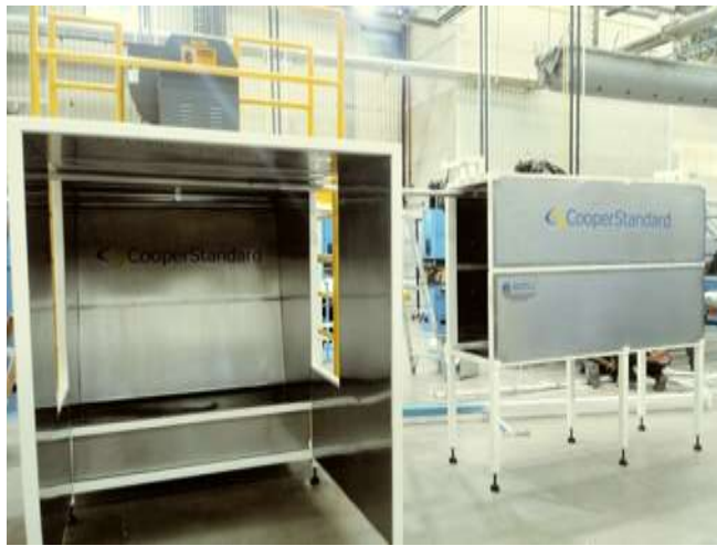
Imagen 48 y 49. Horno de curado instalado y en funcionamiento
