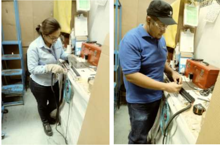
Imagen 23 – Imagen 24. Barrenado e inserción de pin manual
