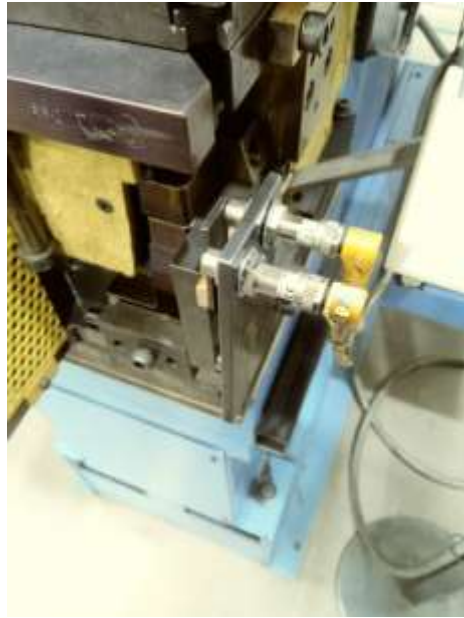
Imagen 52. Sensores en maquinaria instalados
