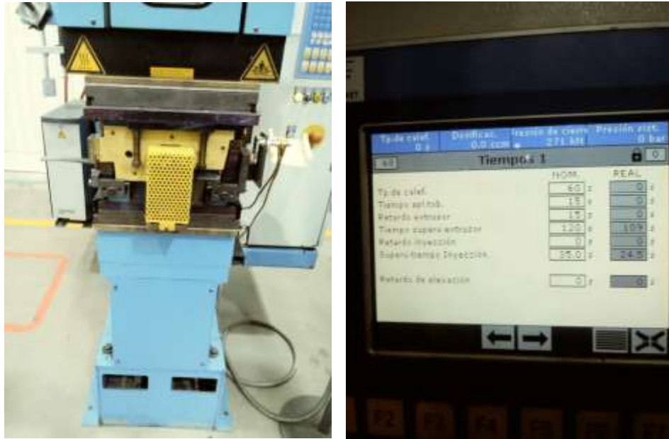
Imagen 44 y 45. Prensa con molde colocado y ajuste de parámetros
