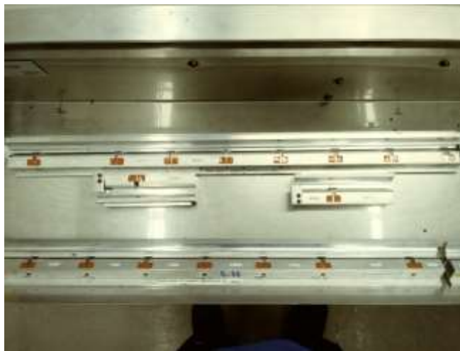
Imagen 47. Gage para la validación de la pieza
