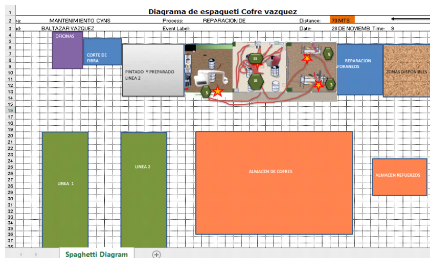
Figura 14 Diagrama de espagueti ya con la aplicación de rack para piezas en reparación
