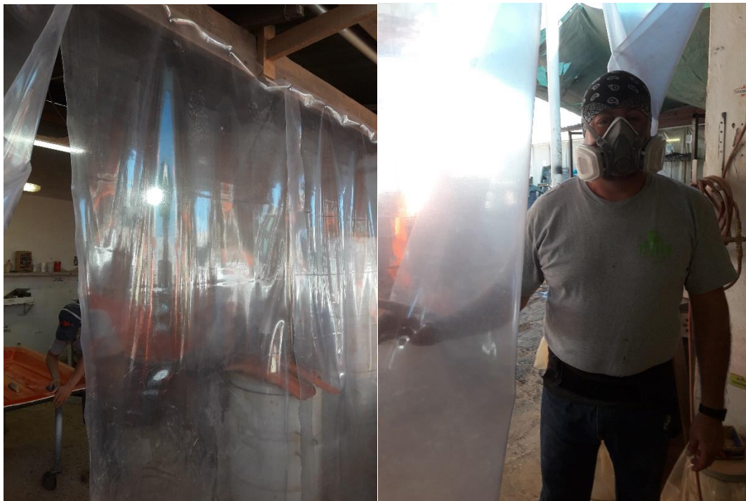
Figura 20 Con la prueba 2samples se determinó que el ambiente si era factor para el secado de cera y se aprovisionó una cortina de Nylon para reducir tiempo de secado
