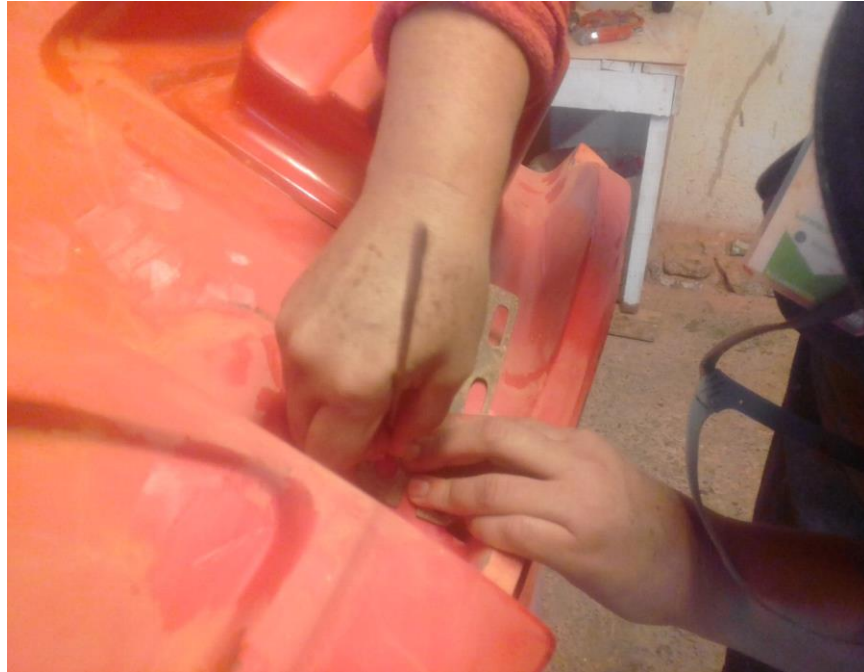
Figura 17 Con la creación de plantillas y puntas de acero que sustituyeron las de soldadura y antes de la operación de pulimento resulto efectiva para reducir retrabajos
