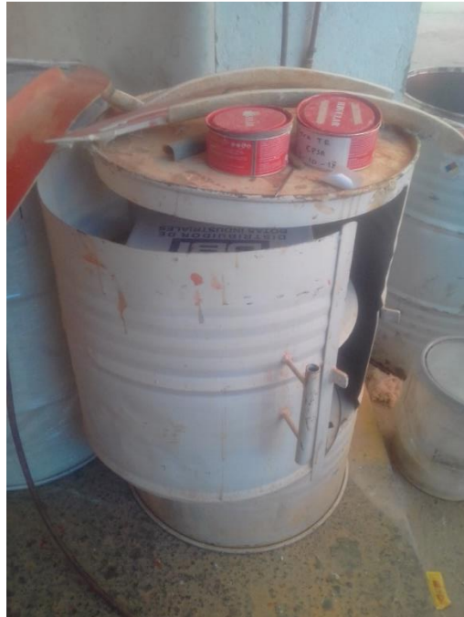
Figura 23 Técnica de aprovechamiento de espacio, corte y puertas a tambo que sirven de mesa de trabajo
