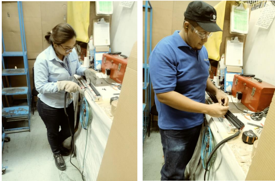
Imagen 23 – Imagen 24. Barrenado e inserción de pin manual
