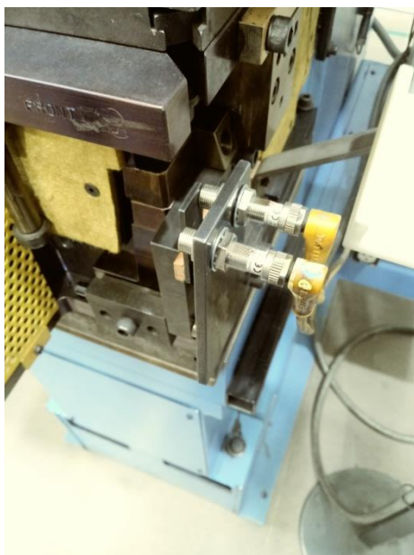
Imagen 52. Sensores en maquinaria instalados
