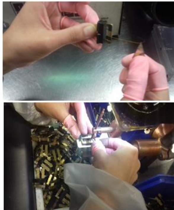
Proceso de soldadura de Hilo en base , esta documentado dar 2 o 3 puntos de soldadura por pieza
