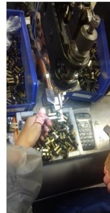
Proceso de soldadura de Hilo en base , esta documentado dar 2 o 3 puntos de soldadura por pieza
