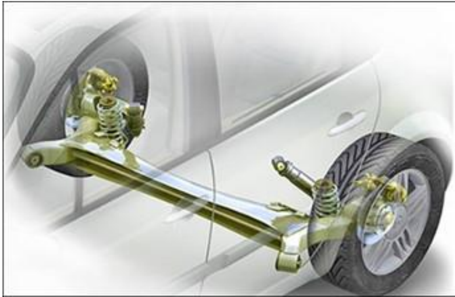
Figura 3. Ubicación de RR BEAM SUSP COMPL.
