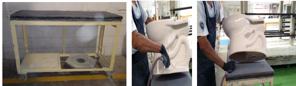
Imagen 33. Mesa mal diseñada y Sopleteo de las piezas.
