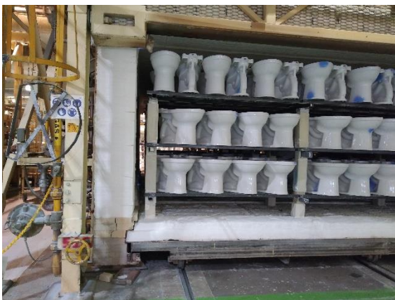
Imagen 36. Material dentro de horno listo para quemar y Curva de quema.
