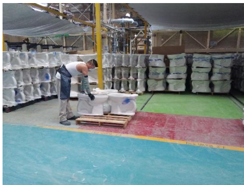
Imagen 30. Piezas con fuga de vacío se colocan en zona roja (desperdicio).
