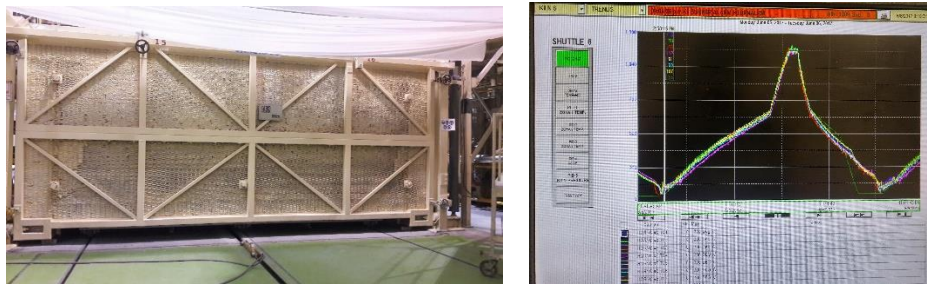
Imagen 4. Horno intermitente y curva de quemado.
