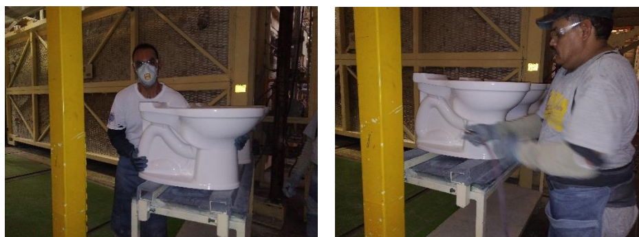
Imagen 59. Mesa de carga modificada y sopleteo de las piezas.
