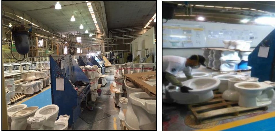
Imagen 28. Mal diseño de Lay Out, con dificultad para estibar.
