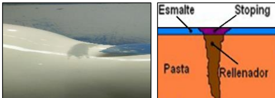
Imagen 48. Planchado del stoping correcto.
