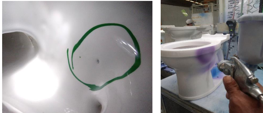
Imagen 20. Piezas mal reparadas.
