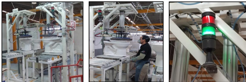
Imagen 57. Máquinas de fuga de vacío, Prueba de fuga de vacío y resultado de prueba OK de la fuga de vacío.
