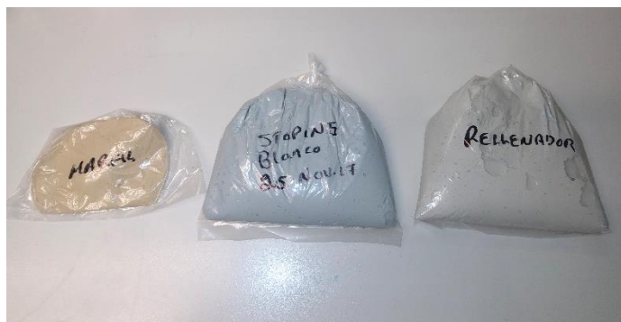
Imagen 52. Diferencia de color en los materiales para resanado.
