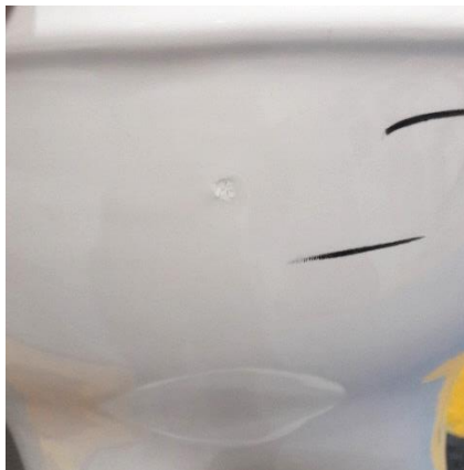
Imagen 26. Reparación errónea con rellenedor.
