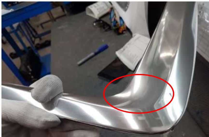
Figura 46: Defectos por líneas de pulido.
