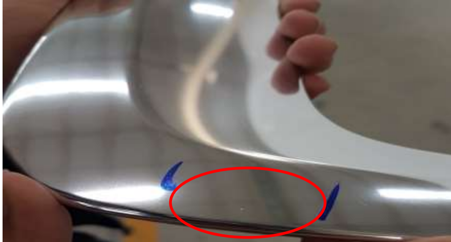
Figura 43: Defectos por puntos de anodizado.
