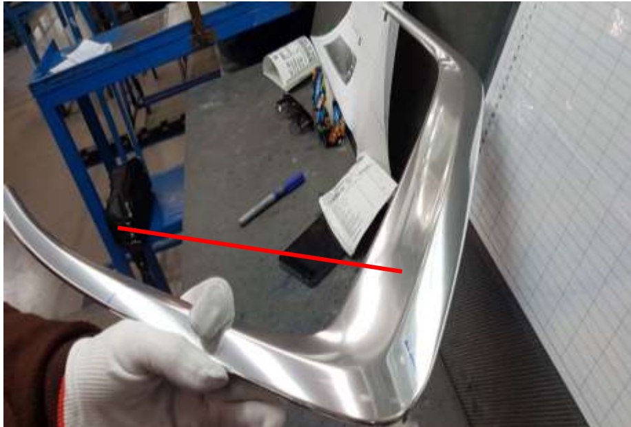
Figura 45: Defectos por diferencias de color.
