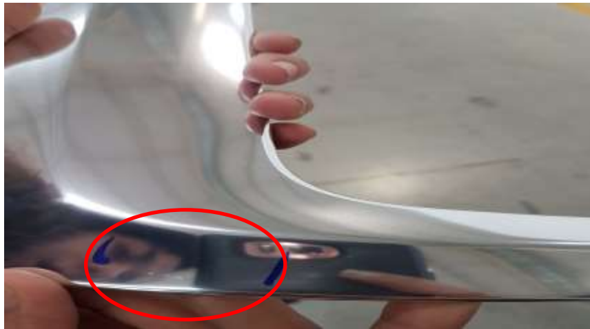
Figura 44: Defectos por daños por manejo.
