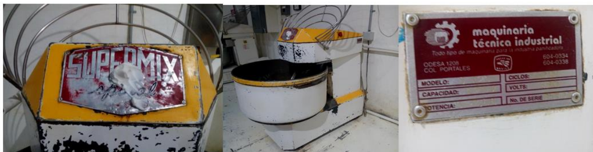
Figura 10. Batidora Supermix de dos velocidades que se utiliza para batir masa de bolillo.
