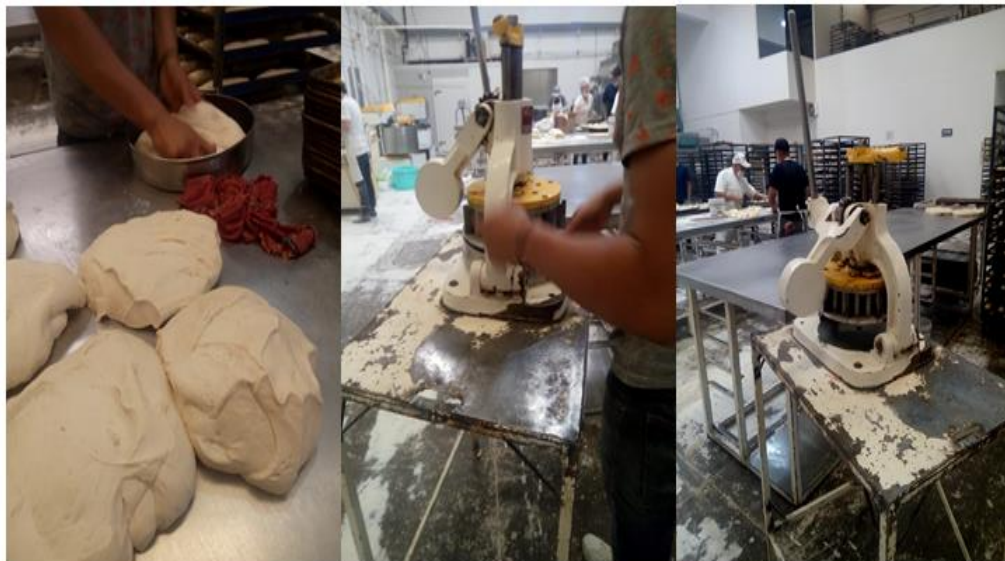
Figura 14. Corte de Bolas de 110 gramos por máquina cortadora.
