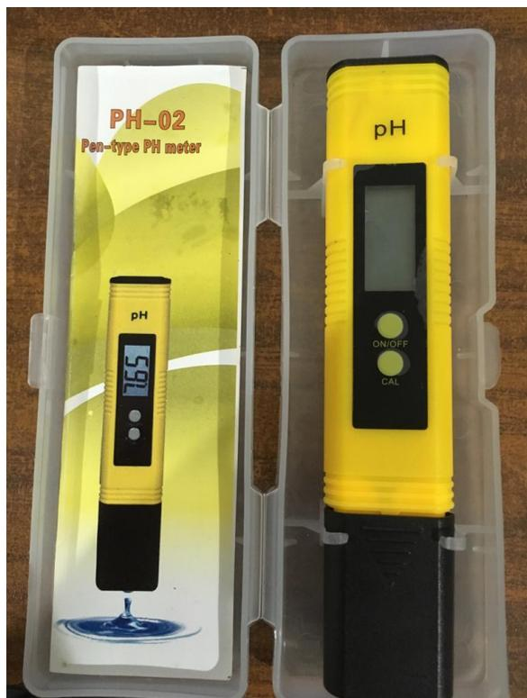
Figura 4.- medidor de PH electrónico tipo lápiz.
