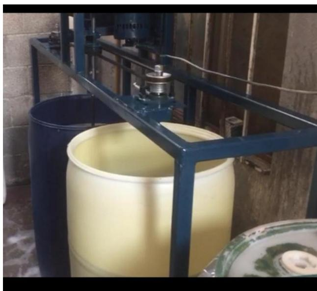
en especificaciones mecánicas. Es por esto que se decidió ir más allá de solo poder mezclar de un tambo y un simple taladro, así que se mandó fabricar una máquina con la capacidad de mezclado de hasta 3 tambores de 220 litros, con esto no solo se estandarizará el mezclado si no, se aumentará la capacidad de producción.
