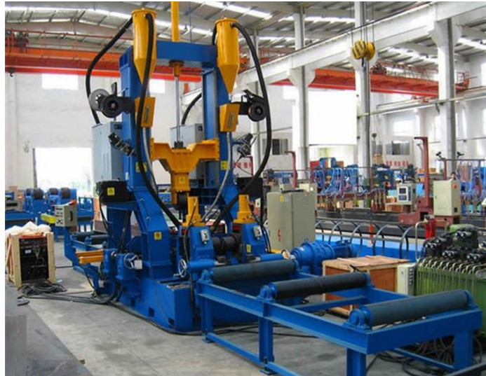
Imagen 5. Máquina para ensamble, soldadura y enderezado de Vigas en H
