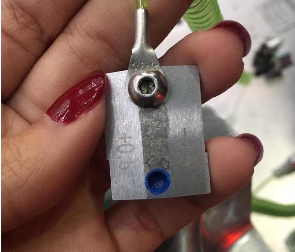
Imagen 8: herramienta con la que se mide el enrace.
