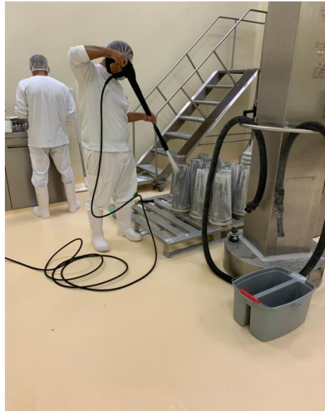
Figura 13. Implementación de la hidrolavadora y realizacion del pre-enjuague
