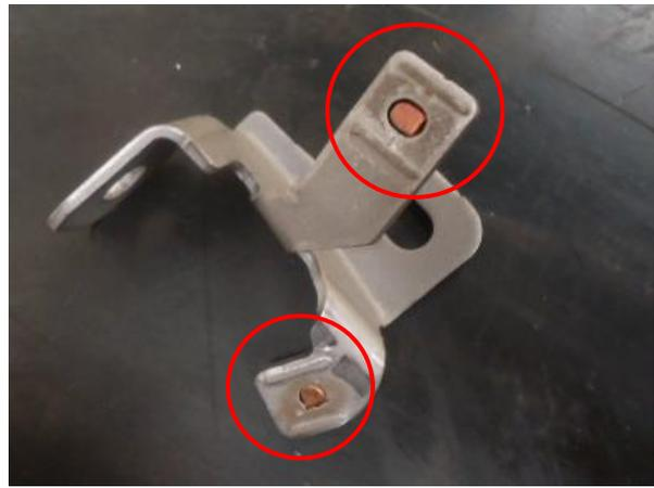
Ilustración 16 Bracket con puntos de proyección especiales
