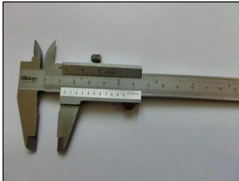
*Ilustración 4 Vernier o pie de rey*
