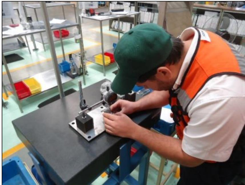
*Ilustración 15 Medición de bracket en puntos de proyección*
