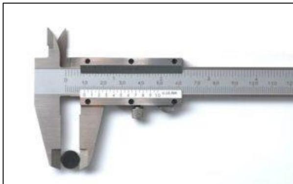
*Ilustración 3 Vernier, permite tomar medidas de longitud.*
