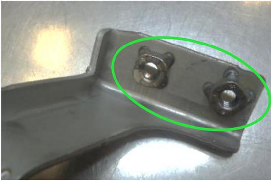
*Ilustración 12 Bracket de fijación por tuerca*
