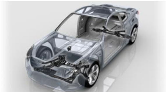
Figura 1. Se muestra las suspensiones tanto delanteras como traseras de las partes ensambladas.
