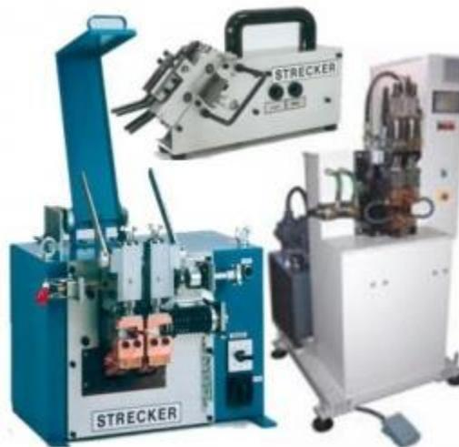
Ilustración 12. Máquina topeadora.
