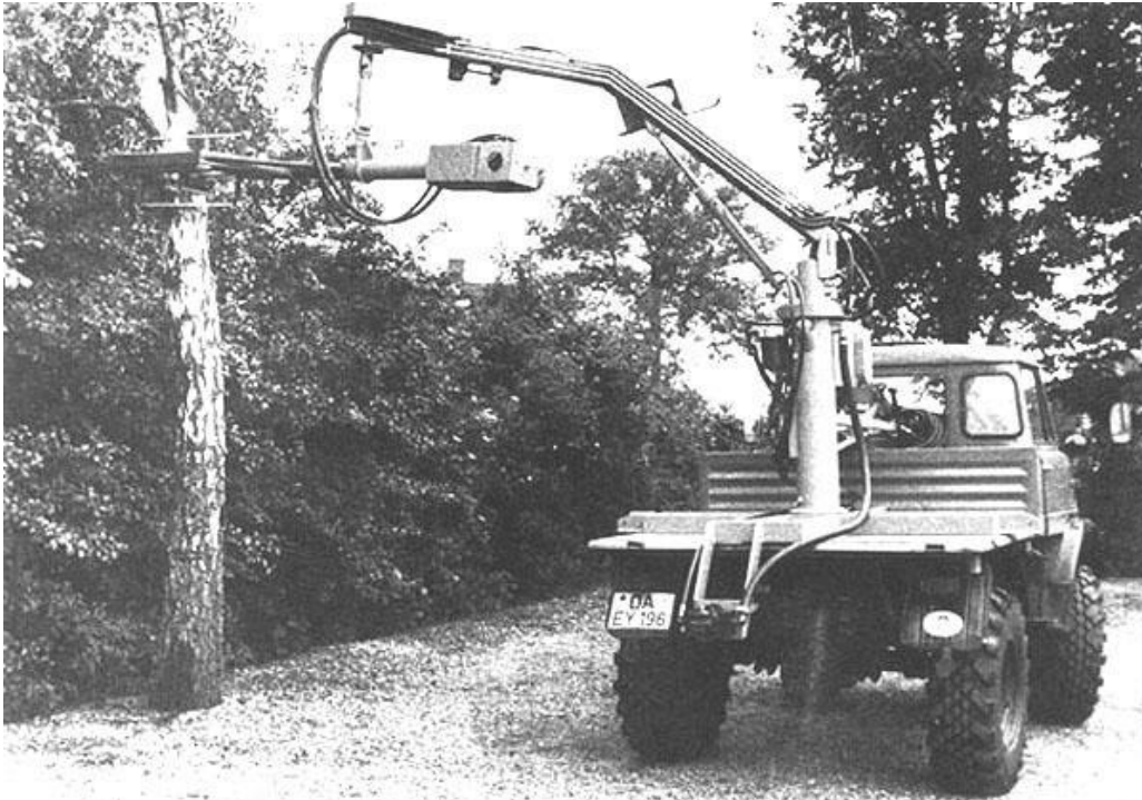
Ilustración 3. Sacudidora de árboles Schaumann. Se trata de una de las diversas marcas de sacudidoras que se pueden encontrar actualmente en el mercado (H.C. Schaumann)
