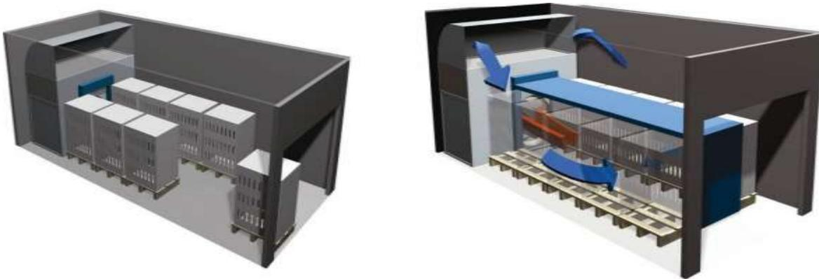
**Figura 12.** Equipos con aire forzado de enfriamiento.
