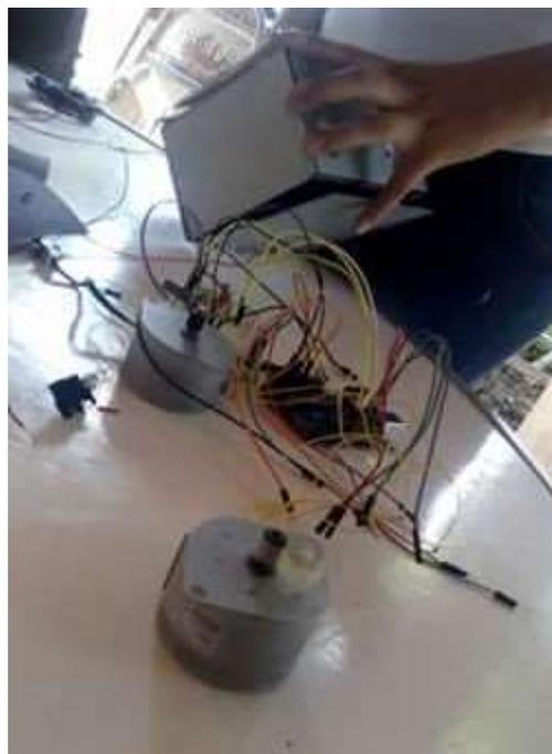
**Figura 26.** Montaje de sistema embebido: motores de plataforma elevadiza.
