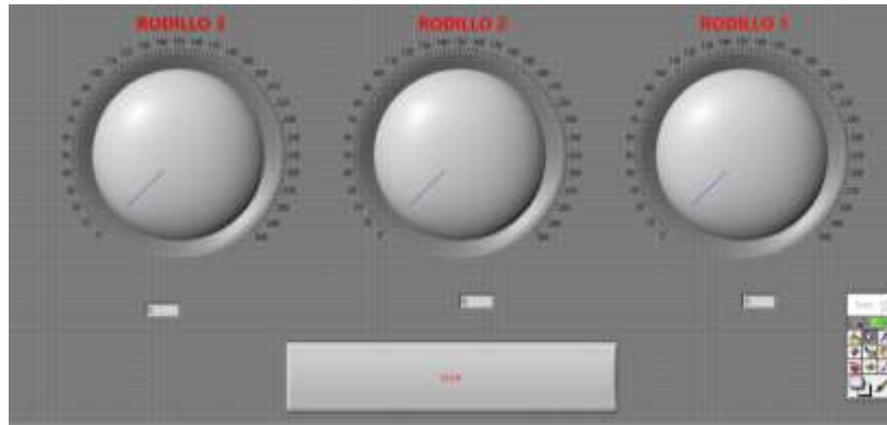
Figura 37. Panel frontal de interacción desarrollada en LabView
