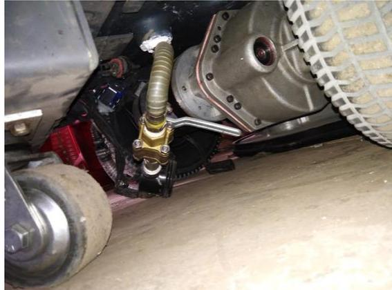
Fig. 14 Electroválvula y transmisión montados en chasis.
