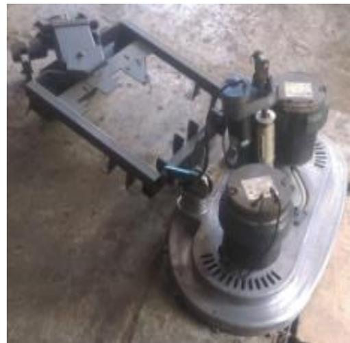
Fig. 15-a Sistema fregado de discos y 15-b Montaje del sistema fregado de discos en el chasis.
