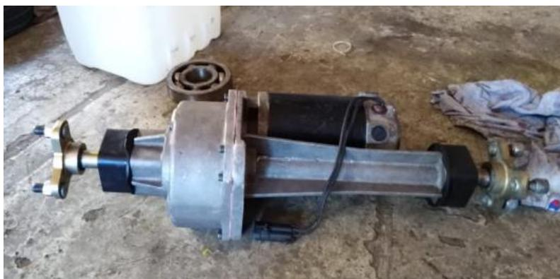
Fig. 13 Transmisión electromecánica de la restregadura reparada.
