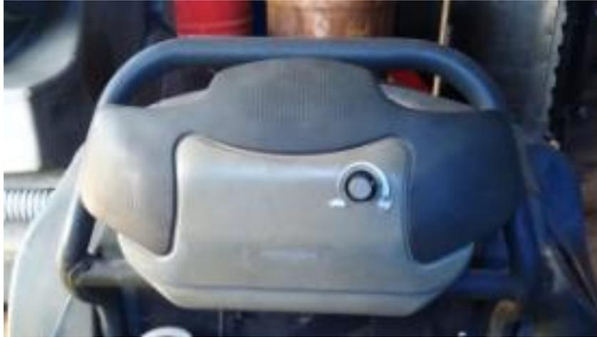
Fig. 16 Pedal de control reparado y montado a la restregadora.
