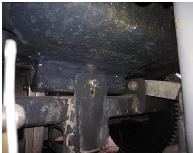
Fig. 12 Tanque soldado con polietileno de baja densidad.
