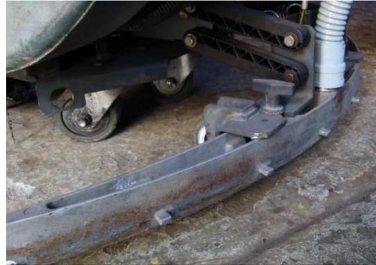
Fig. 18-a Sistema enjugador de agua desarmado, Fig. 18-b Sistema armado y montado al chasis de la restregadora.
