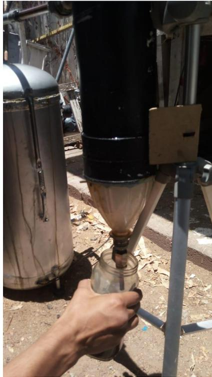
**Figura 34.** Condensador actual: salida inferior de combustibles líquidos.
