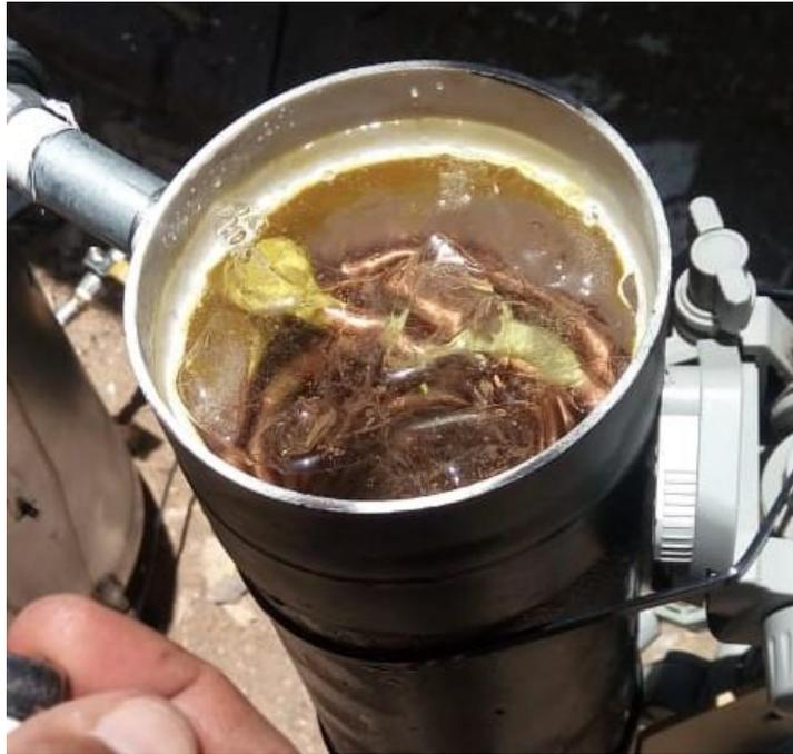
**Figura 32.** Condensador actual: interior – serpentín con hielo a granel.
