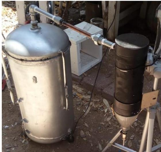
**Figura 31.** Condensador actual acoplado a reactor pirólítico.
