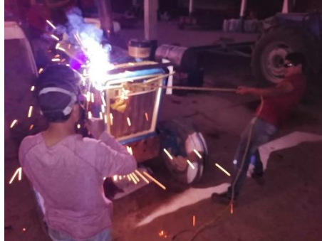
Ilustración 57. Proceso de soldadura a base del tractor.
