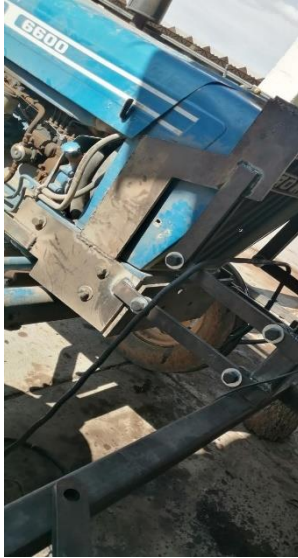
Ilustración 59. Base del tractor con sujetadores.
