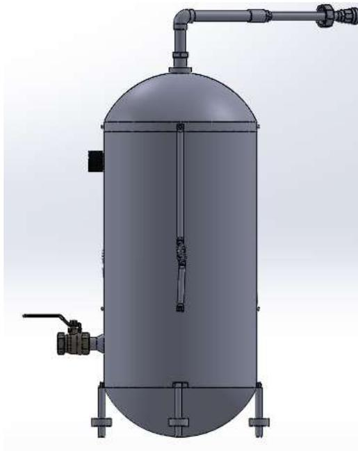
**Figura 28.** Vista lateral del reactor hecho a la medida.
