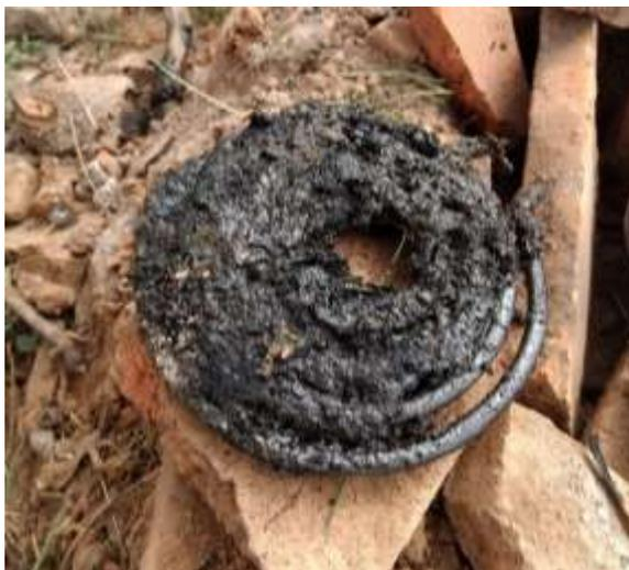
**Figura 27.** Tipo de resistencia eléctrica de tipo espiral del reactor actual.
