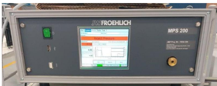
Figura3: Módulo JW FROEHLICH Leak Test Panel MPS 200
