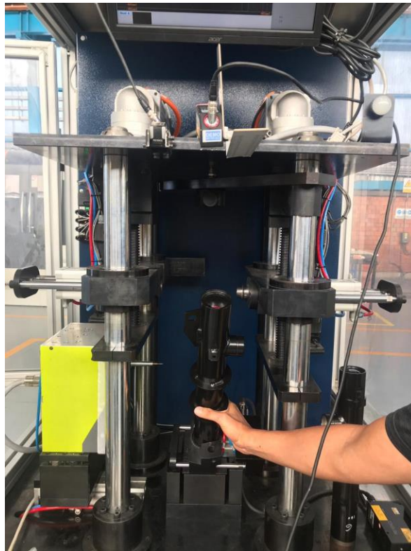
Figura 11: Colocación de Piezas en Máquina Checa Fugas.
