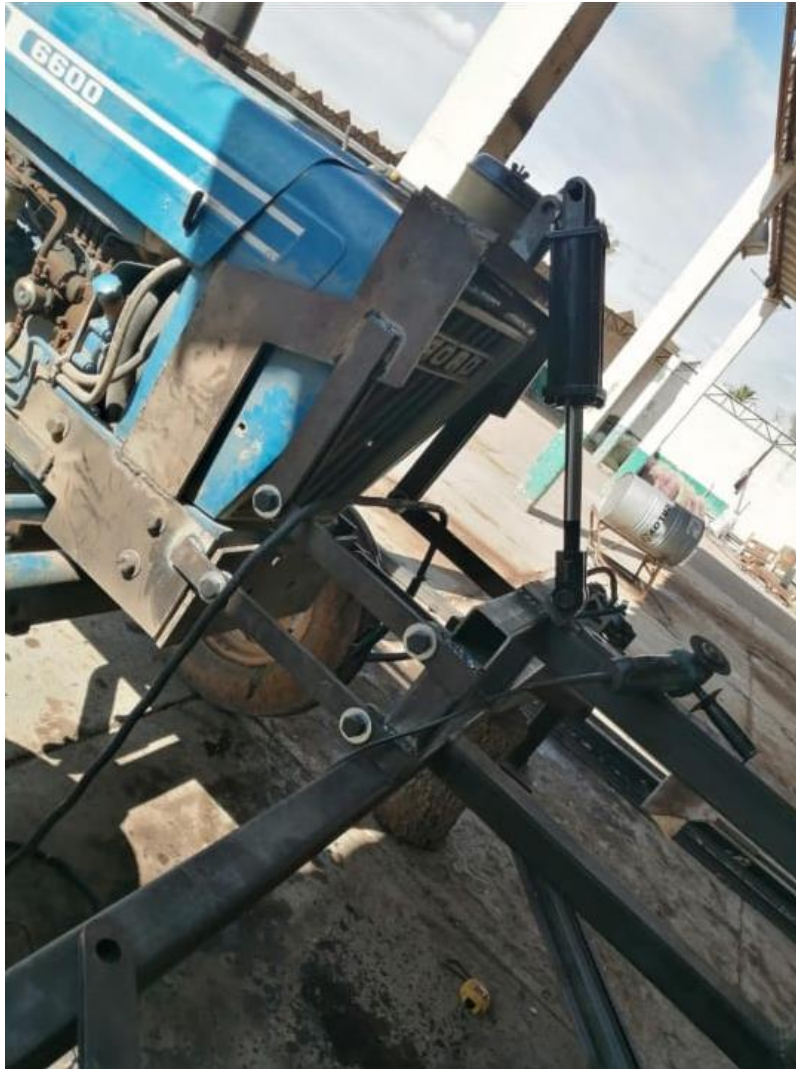
Ilustración 64. Levantamiento con pistón.
