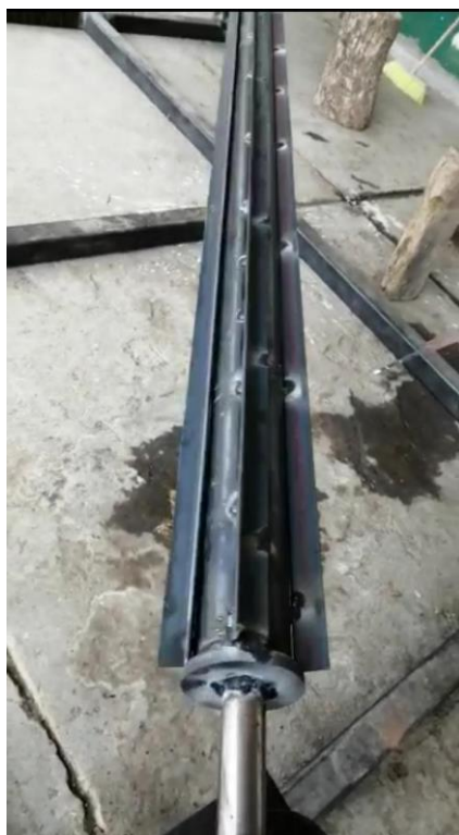
Ilustración 55. Flecha con sujetadores para hules.
