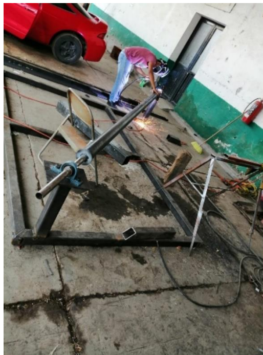
Ilustración 53. Cortes con máquina de plasma.
