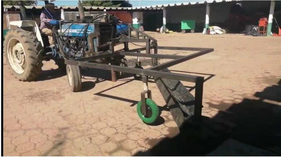
Ilustración 65. Levantamiento con pistón y barrido nuez.
