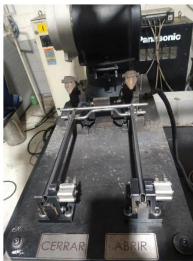
*Imagen 42: Pokayoke de colocación de piezas MAL HINTEN*
