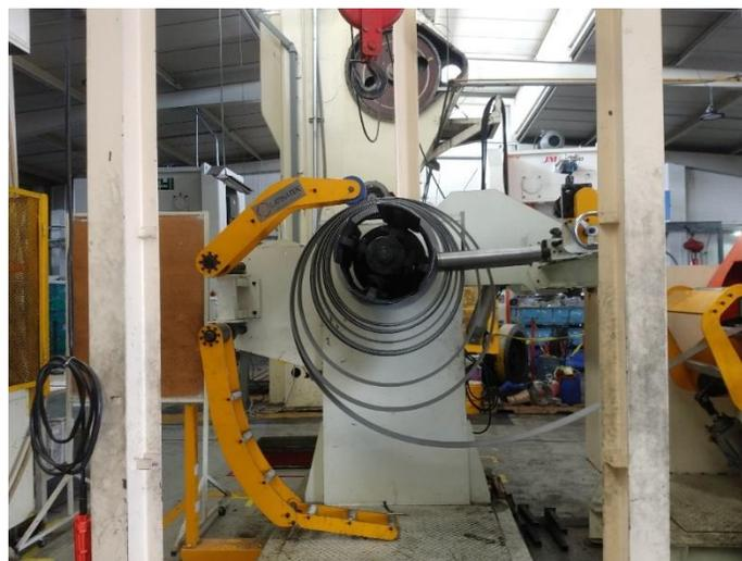
*Imagen 21: Montaje de rollo metálico*
